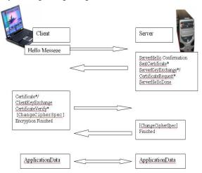
Fig: 1. TLS Handshake Flow Diagram
